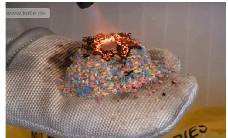
トーチを使用して強制的に火を付けても引火されません。
